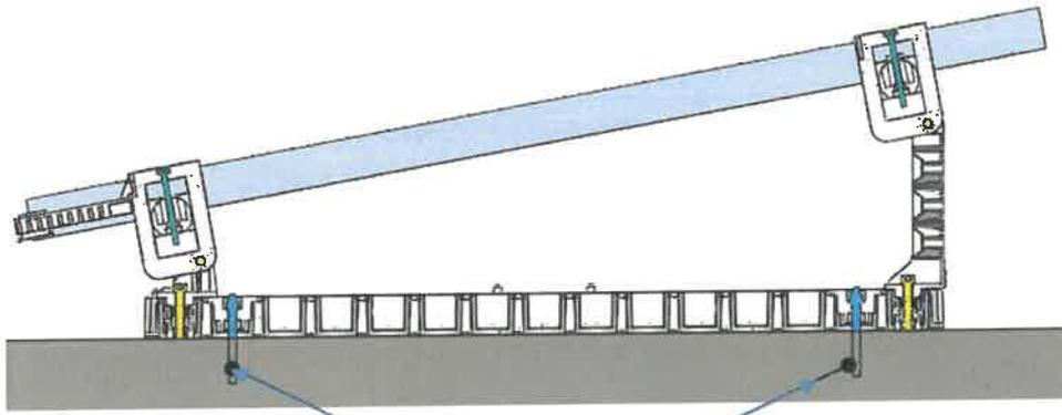
Dans ce cas de figure, il est important que la longueur des chevilles (et du perçage des dalles béton) n'excède pas l'épaisseur de la dalle de répartition, pour ne pas générer de désordre sur le complexe d'étanchéité
