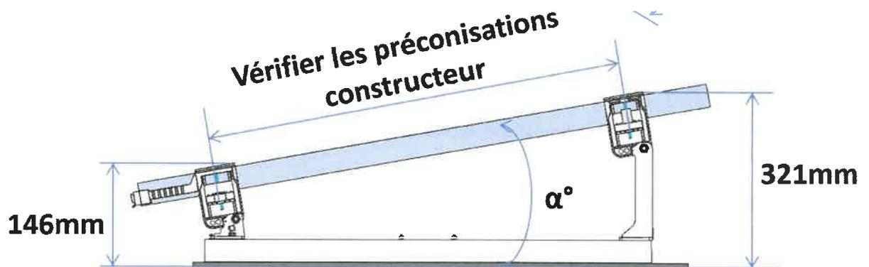
La hauteur de l'arase supérieure de la bride inférieure est toujours de 146mm par rapport au niveau d'assise des socles (cf schéma ci-avant)
