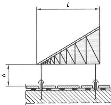
Figure 2 Hauteur minimale libre sous équipement technique fixe
