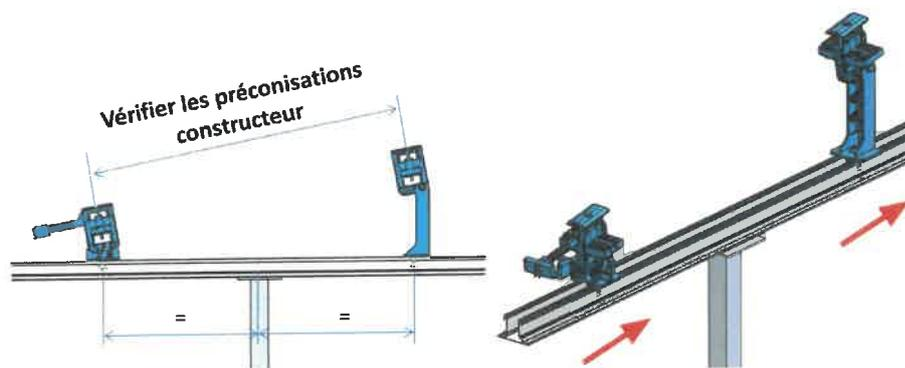
Dans ce montage, le rail est fixé sur des piètements métalliques (acier inox A304L ou Aluminium ENW6063 T66), à l'aide de **boulons inox A2** (non fournis par EDILIANS, et à dimensionner par l'installateur).
