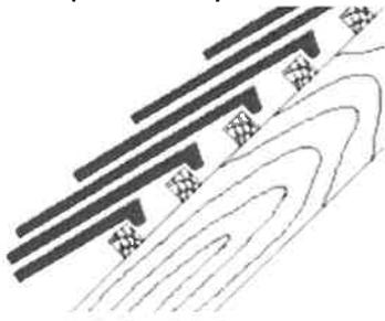
❖ **AVEC LES CROCHETS DESTINES AUX COUVERTURES EN TUILES EN BETON à emboîtement à pureau plat**
