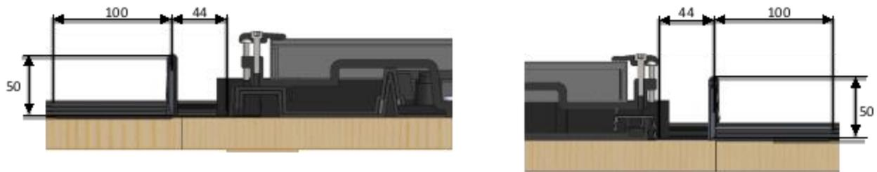
**Figure 66 - Mise en place des éléments de couverture pour le Kit ARD**
