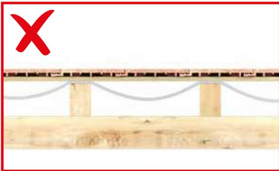
La pose « en auget » d'un écran souple de sous-toiture est désormais interdite, seule la pose tendue est permise.
