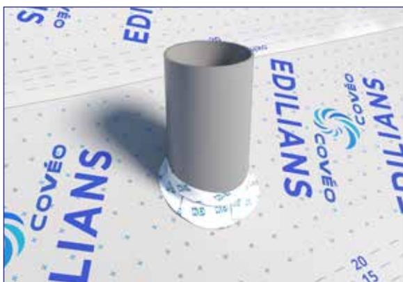
Le raccordement en toiture est assuré par une tuile à douille dotée d'un adaptateur en sous-face. Dans ce cas, puisque l'adaptateur le traverse, le raccord conduit ne pourra se faire qu'après la pose de l'écran.
