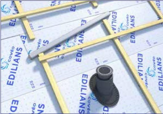
Le principe de réalisation est similaire à celui pour l'entourage de fenêtre de toit. Les eaux de fonte de neige poudreuse infiltrée seront ainsi déviées en amont par le déflecteur sur des parties adjacentes.
