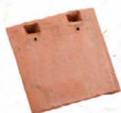
Tuile courte d'égout et de faîtière PLATE ELIXIR 16X27 Auboiss (6,3 par ml à l'égout et 12,6 par ml au faîtière) Réf. 511.13
