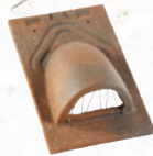
Tuile de ventilation 17x27 grille métallique (section de ventilation 35 cm 2 ) Réf. 599.20
