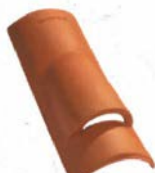
Tuile châtière CANAL GIRONDE 50 Poudoux (section sans grille = 21 cm 2 ) Réf. 406.21 (2)
