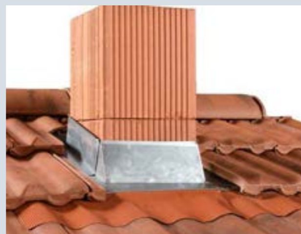
6- Re-positionner les tuiles périphériques avec un espace d'écoulement des eaux pluviales supérieur à 8 cm. Finir l'ouvrage en tirant un joint mastic entre le boisseau et l'abergement.
