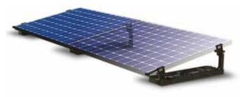
mm, il dispose d'une pente ajustable pour s'adapter à toutes les situations : parallèle au toit, de 10° à 14° (1 châssis par module), de 8° à 14° (configuration inter-module). Léger et résistant, chaque châssis Easy Roof Flat intègre tous les composants nécessaires à la fixation des modules par rail ou par socle. Sa mise en œuvre s'effectue ainsi de façon rapide et économique.
