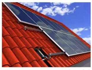
en surimposition s'installe ainsi par-dessus la couverture existante tout en étant fixé directement sur la structure du bâtiment. Disponible en portrait, il peut également être posé en mode paysage. Grâce à une embase spécifique, une simple rotation de rail suffit, ce qui représente un véritable gain de temps lors de la mise en œuvre.
