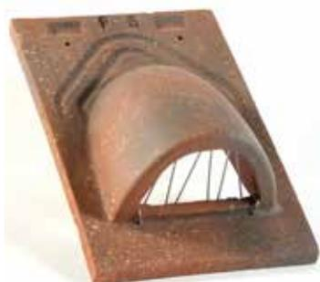
Epousant la forme de la châtière, la grille métallique, installée en usine, protège contre l'intrusion des nuisibles et des feuilles. Réalisée en acier galvanisé, elle offre une très bonne résistance aux cycles gel/dégel et assure sa durabilité (garantie 30 ans).
