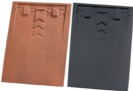
D'un très grand format (265 x 370 mm), la tuile plate STRETTO Huguenot d'EDILIANS permet une pose rapide de la couverture. A raison de 25 à 27 tuiles/m<sup>2</sup> selon pureau (140, 145, 150), elle répond aux prescriptions de 27 tuiles m<sup>2</sup> tout en offrant un véritable gain de temps aux couvreurs et constructeurs de maisons individuelles.
