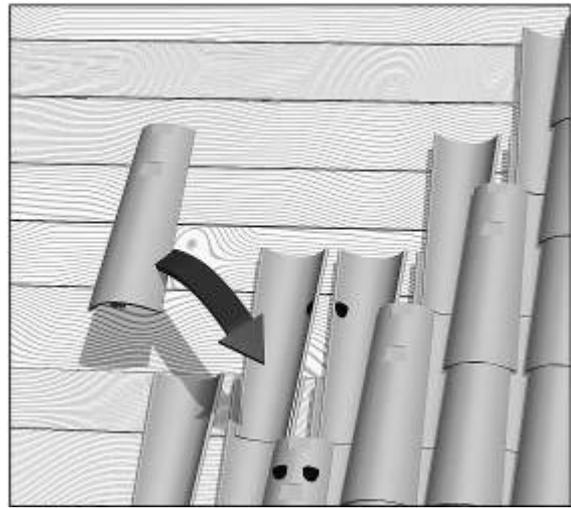
Figure 11 - Tuile de couvert en partie courante - Collage
