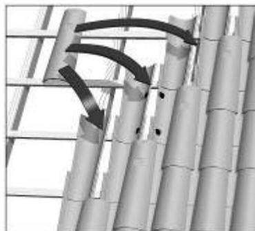
Figure 16 - Tuiles de couvert en partie courante - Collage
