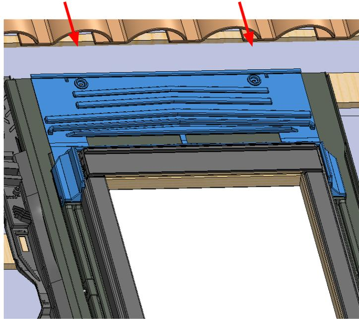
11 °) Finaliser le montage de la fenêtre Velux en replaçant la partie ouvrante sur le dormant.
