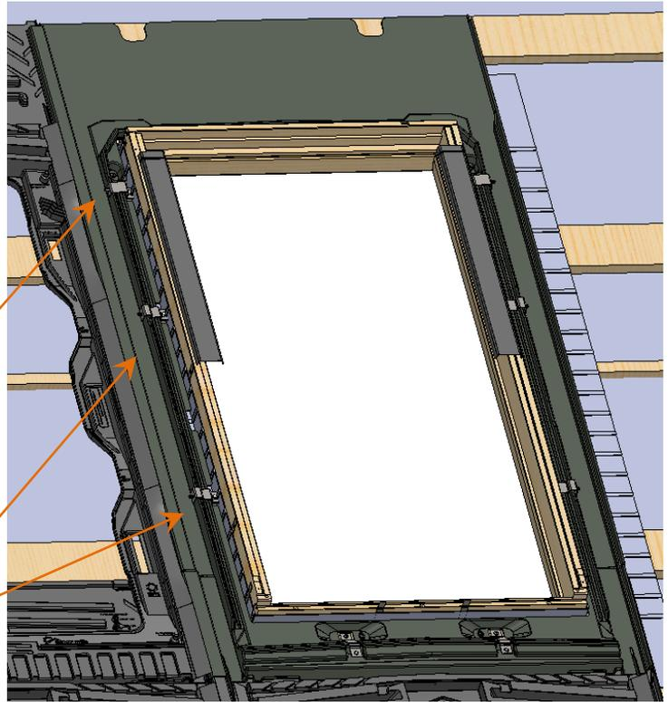
4°) Mettre en place l'abergement bas (C2) en appui avec le dormant de la fenêtre. Visser avec 2 vis HM12x5 (7) et 2 rondelles épaulées (9).
