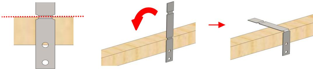
2°) Positionner et plaquer le gabarit sur un côté du dormant (A4 ou B4 selon format de la fenêtre).
