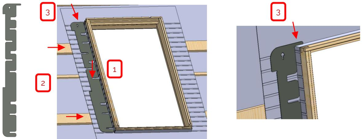
3°) A l'aide des logements dans le gabarit, positionner les pièces de fixations (3) x3 et (1) x4 (de chaque côté du dormant) l'une après l'autre, bien les plaquer sur le côté du dormant, puis visser avec les vis 5x30 Inox (10).
