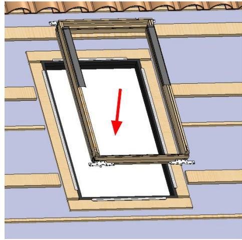
3°) Mettre en place Colerette d'étanchéité de sous-toiture BFX 1000 en respectant les recommandations du fabricant.
