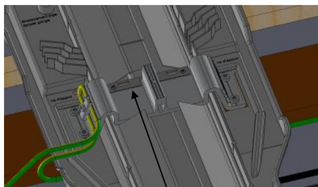
Arrivée des câbles entre deux laies ( + / - et terre )
