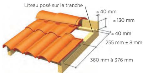
Faîtière/arêtier à pureau variable ou à bourrelet à emboîtement et tuile sous-faîtière 2/3 pureau.
