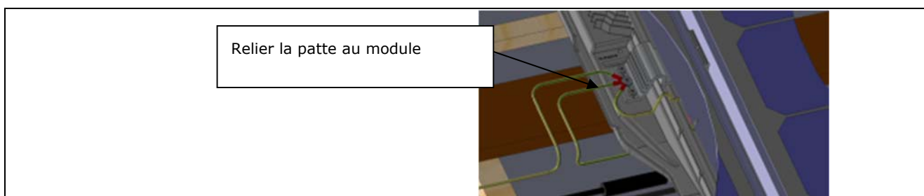
Figure 26 – Liaison équipotentielle des masses
