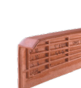
Rive individuelle à emboîtement ALPHA 10 Ste Foy (2,7 par ml au pureau de 375 mm) Gauche Réf. 200.42
