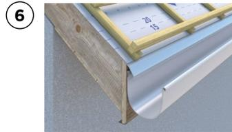
6 En égout, le raccordement de l'écran s'effectue sur le larmier afin d'évacuer l'eau récupérée dans la gouttière. L'écran recouvre de 10 cm la bande rigide et est coupé au ras de l'égout.
