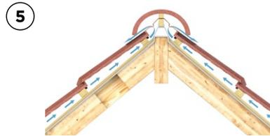
5 L'écran HPV peut être au contact de l'isolant. En faitage celui-ci est fermé par la mise en œuvre d'une bande d'écran de débord 20 cm et centrée. La non-ventilation en sous face de l'écran HPV APNEO assure une performance thermique optimisée de l'isolant.
