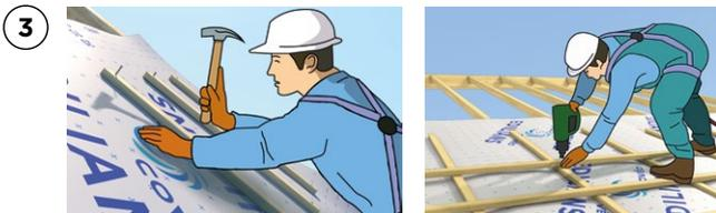
3 L'écran est maintenu définitivement par un contre lattage cloué au droit et au travers de l'écran dans les chevrons ou fermettes. La contre latte de section minimale de 36 x 20 mm crée une lame d'air de 2 cm minimum entre l'écran et la couverture.
