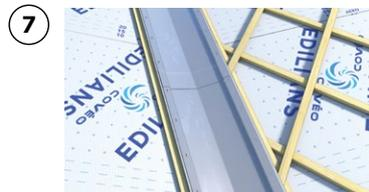
7 Traitement des noues par système de déflecteur et liteau de basculement.
