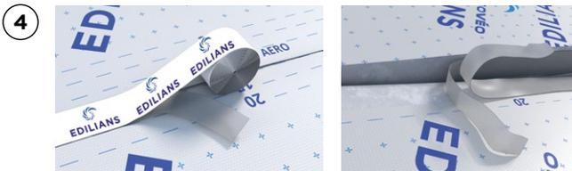
4 La bande adhésive est appliquée de manière continue avec le retrait de la bande PE de protection. Avec la double bande adhésive, le collage colle sur colle implique le retrait simultané des bandes de protection PE inférieures et supérieures.
