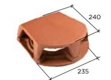
Lanterne bi-section Ø 126 et Ø 160 (section d'aération 259 cm<sup>2</sup>) (conforme VMC)
